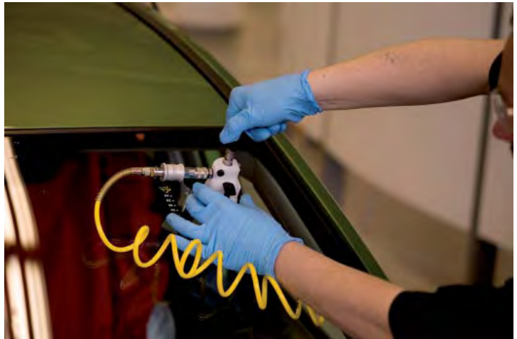
Injection de résine par un technicien Carglass
